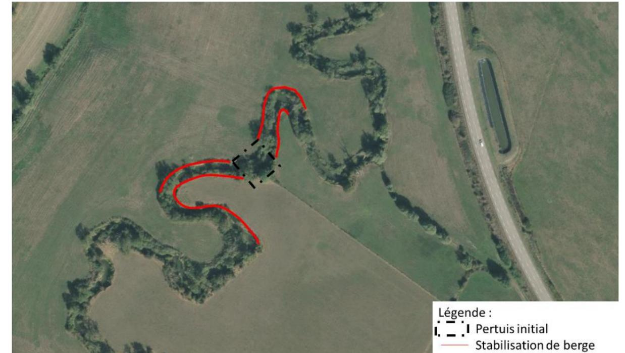
**Fig. 4. Stabilisation de berge à mettre en place pour sécuriser les méandres et l'aménagement pour le positionnement initial**
