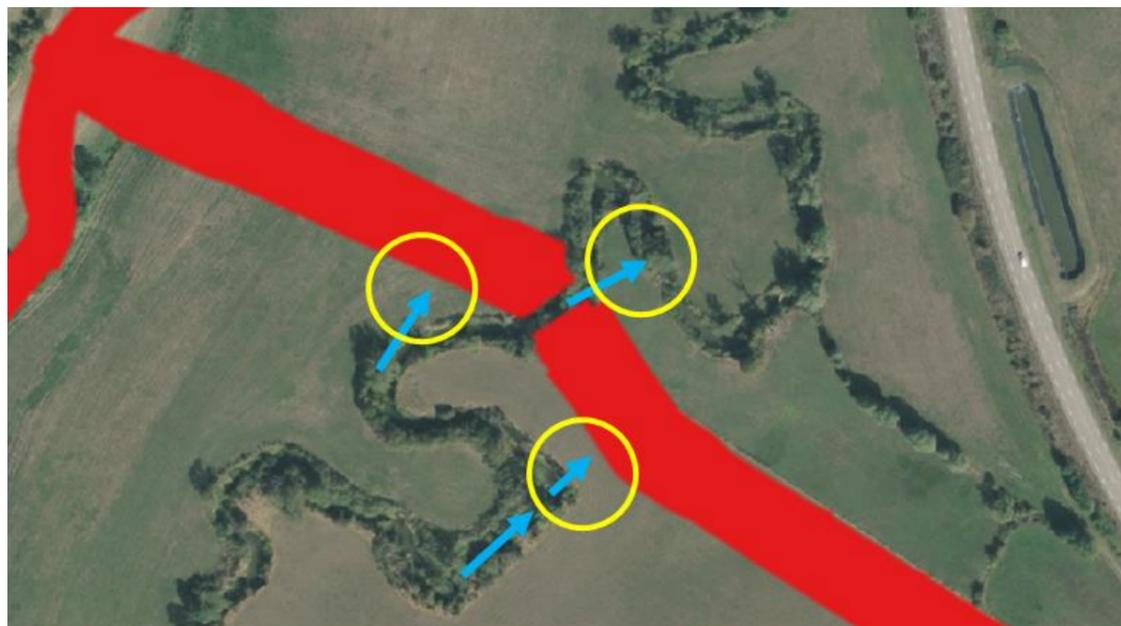
**Fig. 3. Sens des écoulements en situation de débordement du cours d'eau**
