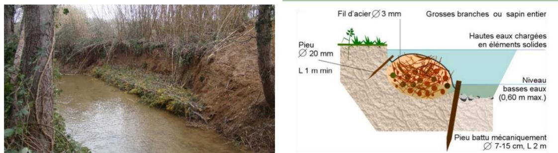
Fig. 9. Technique de peigne (source : A. Peeters)
