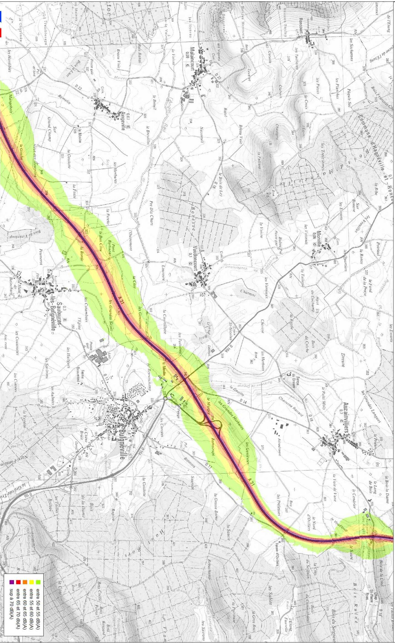
Carte de type A localisant les zones exposées au bruit, à l'aide de courbes isophones en Ln (Level night) par pas de 5 en 5, de 50 dB(A) à supérieur à 70 dB(A)
