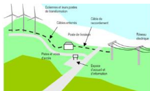
Schéma descriptif d'un parc éolien
